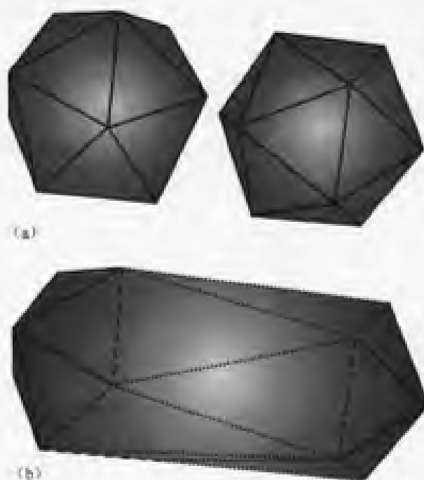
图 13.40 (a) 两个二十面体。(b) 合并的包。虚线标识部分原包的面的边。点线表示部分新增的面的边
